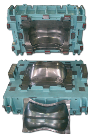
(Produto: Ferramenta de estampagem profunda para produzir reforço de pára-choques de camiões Volvo)
